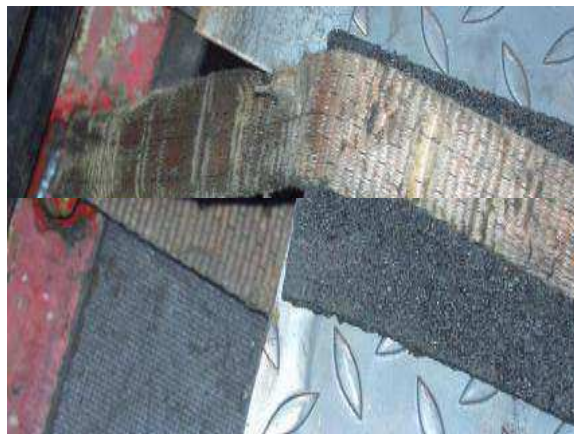
Abb. 31: Ablegereifer Gurt mit Antirutschmatte als Kantenschutz
