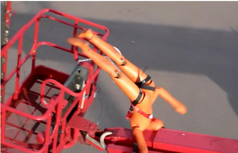
Bild 2: Sturzsequenz aus Teleskoparbeitsbühne durch Katapulteffekt (Peitscheneffekt) und Einsatz eines zu langen Verbindungsmittels. → Videos auf [www.bauforumplus.eu/absturz](http://www.bauforumplus.eu/absturz)
